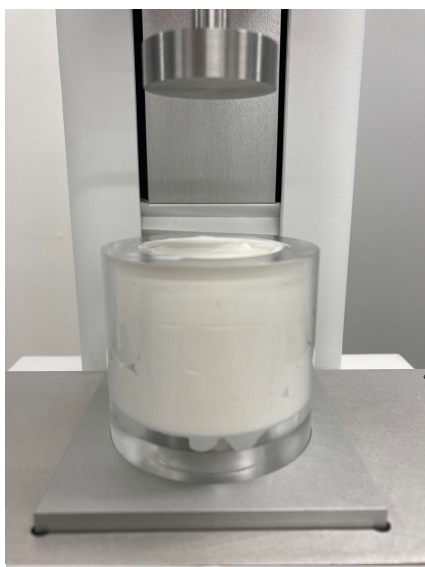
押し出し治具に試料を充填した時の様子
