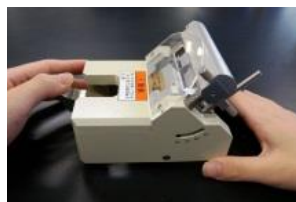
Slice Master HW-1で 多層膜フィルムをカット
