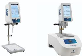
モーターに流れる電流からトルクを検出する方式の回転粘度計です。コーンプレート型は少量のサンプルで粘度変化測定や流動性評価ができます。
